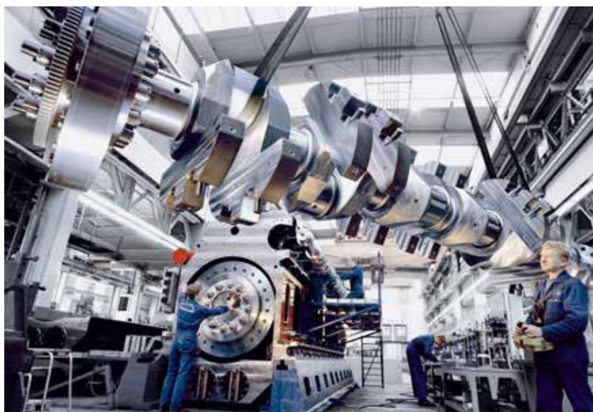
In der Motorenmontage von MAN Diesel & Turbo schwebt eine Kurbelwelle zum Einbau
