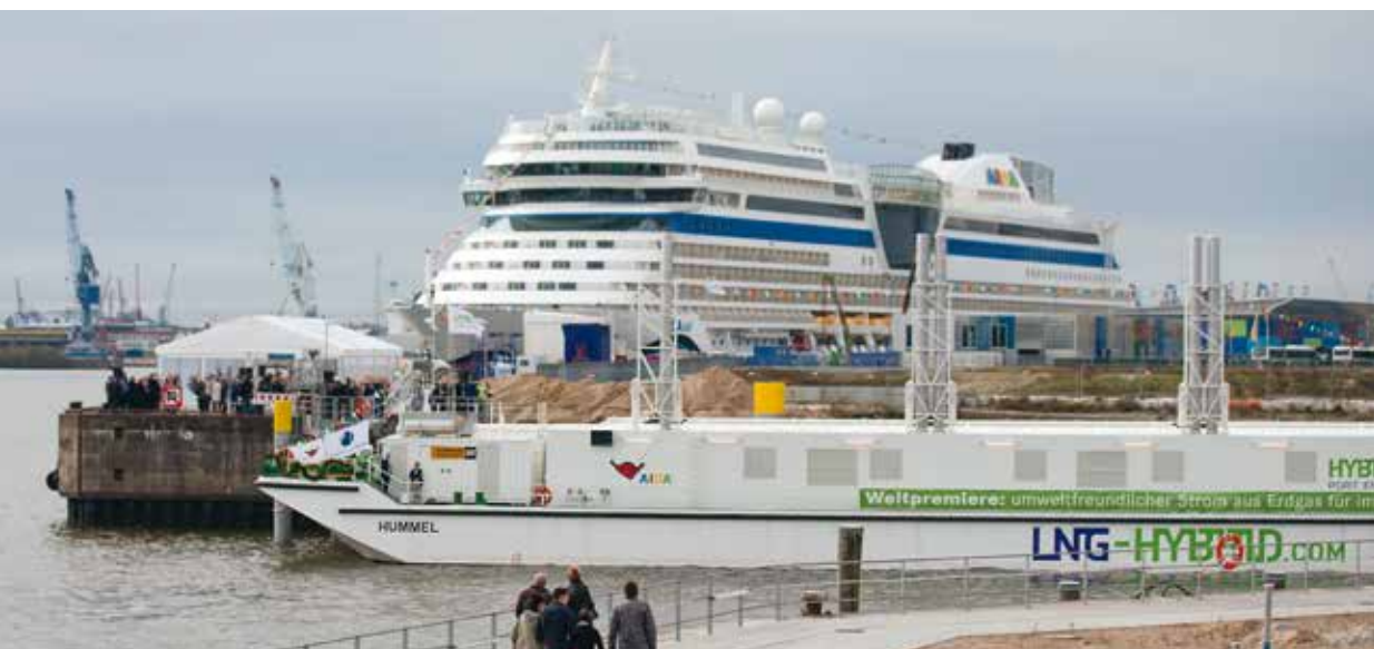
Weltpremiere 2015 in Hamburg: Die LNG Hybrid Barge „Hummel“ versorgt die „AIDASol“ mit emissionsarmem Strom
